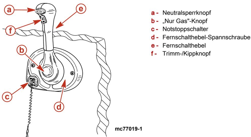
**Neutralverriegelungsknopf.** Verhindert unbeabsichtigtes Schalten und Gas geben. Der Neutralsperrknopf muss eingedrückt werden, um den Fernschalthebel aus der Neutralstellung ziehen zu können.
