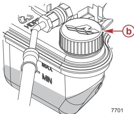
Flüssigkeitsstand im Power-Trim-Pumpenflüssigkeitsbehälter liegt unter der „MIN“ Markierung
