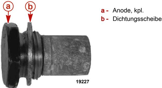
2. Die Anode und Unterlegscheibe in den Nachkühler-Enddeckel installieren und fest anziehen.
