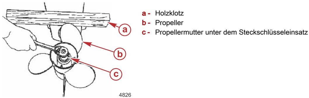
3. Die Propellerwellenmutter gegen den Uhrzeigersinn drehen und entfernen.
