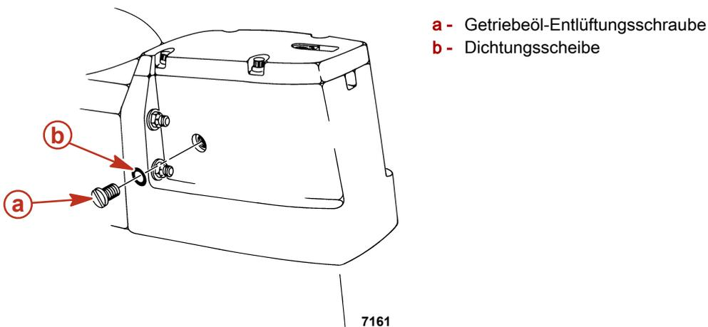
a - Getriebeöl-Entlüftungsschraube
