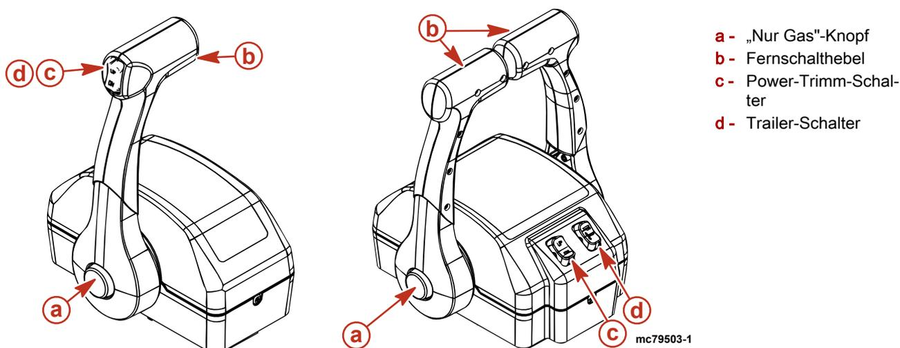
**Nur-Gas-Knopf.** Ermöglicht das Verschieben des Gashebels ohne Einlegen des Ganges. Hierzu wird der Schaltmechanismus vom Fernschalthebel getrennt. Der Nur-Gas-Knopf kann nur gedrückt werden, wenn die Fernschaltung auf Neutral steht.
