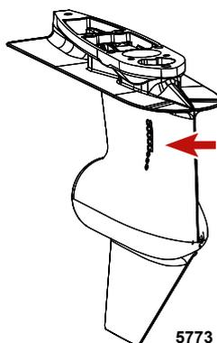
**Seitlicher Wassereinlass am Alpha Z-Antrieb**
