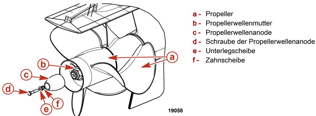
4. Die hintere Propellerwellenmutter gegen den Uhrzeigersinn drehen und entfernen.
